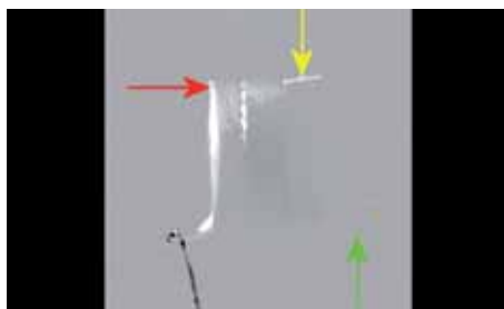
Abb. 7: Einströmende Luft in den Oxygenator: aus lateraler Richtung (li.) und sagittaler Richtung (re.); rote Pfeile markieren Sitz der hydrophoben Entlüftungsmembran, gelber Pfeil markiert Druckmesskonus des arteriellen Filters, grüner Pfeil markiert Sitz der arteriellen Linie.
